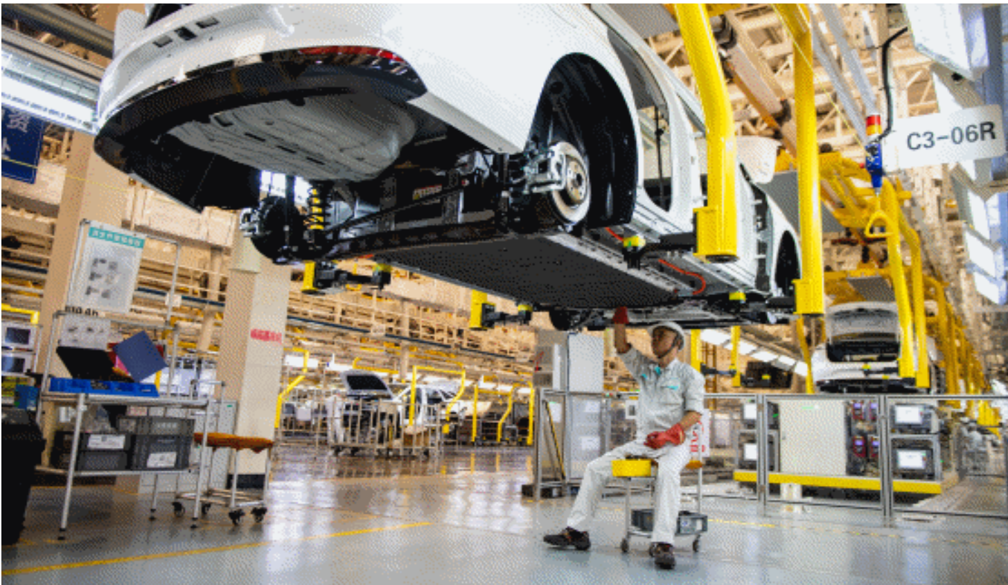
广汽埃安长沙工厂是全球最快单线节拍工厂，53秒即可下线一台车。长沙晚报全媒体记者 郭雨滴 摄
