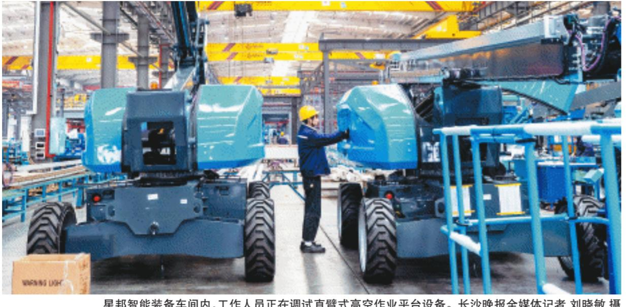
星邦智能装备车间内,工作人员正在调试直臂式高空作业平台设备。长沙晚报全媒体记者 刘晓敏 摄
