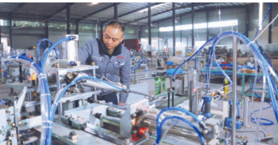
在金刚镇博士机械生产车间,技术员正在调试全自动花炮生产线。长沙晚报全媒体记者 颜开云 摄
