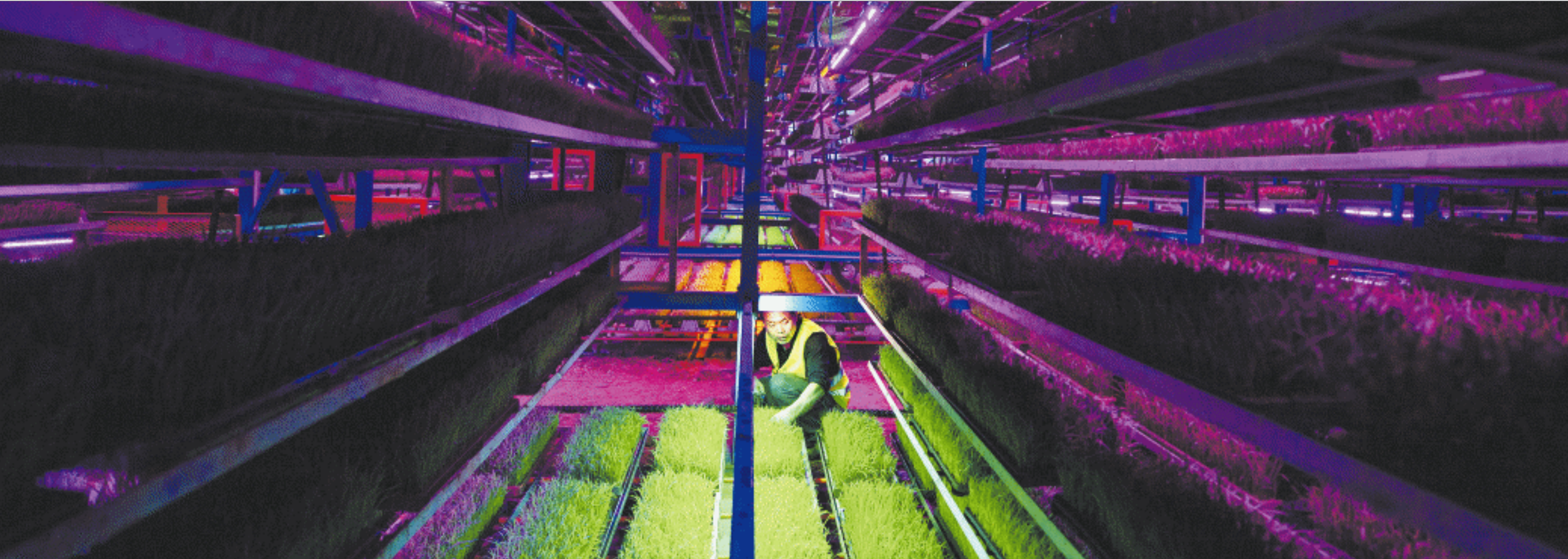
长沙县春华镇智能化育秧工厂里,层层叠叠的育秧盘可上下往复,被赤橙黄绿青蓝紫的人工“太阳”照射,开启24小时全天候的生长模式。
