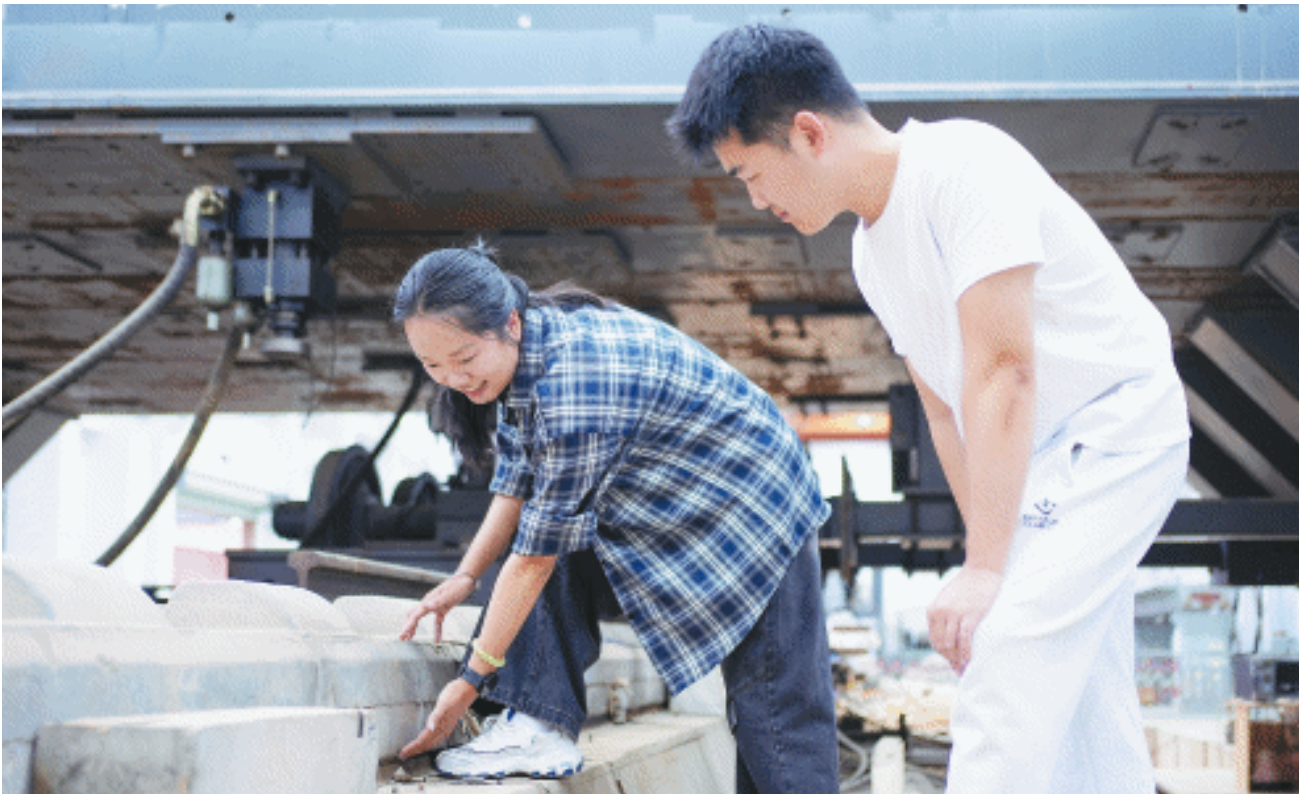
楼婉婷团队瞄准高铁轨道板下病害检测，研发了通过空气耦合超声波实现非接触式检测的自动检测装备。长沙晚报全媒体记者 何文瑞 摄
