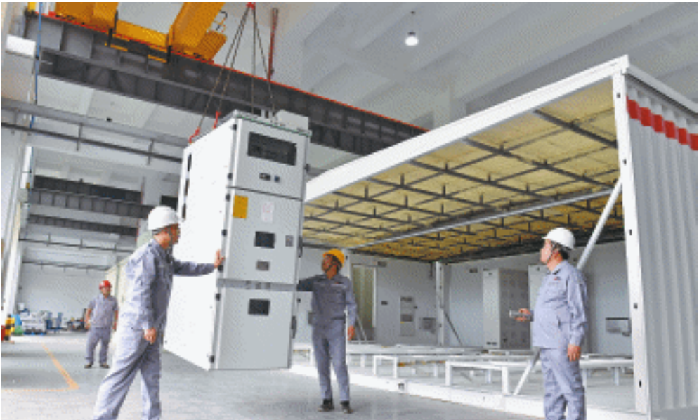
日前, 湘能楚天集成车间内, 工作人员正在吊装预制舱内相关设备。
