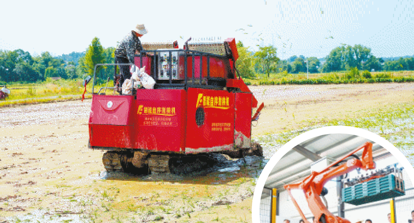
自序抛秧机综合运用机械、流体、控制等技术手段,实现自动下秧匀秧、风送均匀抛撒的功能。均为长沙晚报全媒体记者 冯启阳 摄
