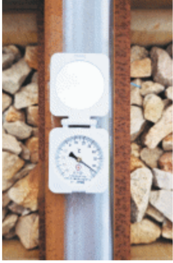
22日中午,测温设备检测铁轨轨面温度高达65.5℃。
