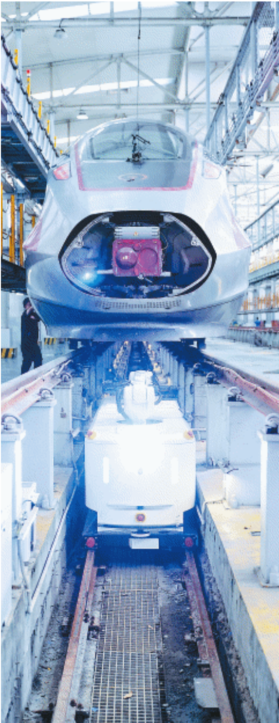
动车组车底检测机器人穿梭在动车底部进行自动检测。均为长沙晚报全媒体记者 易亿摄
