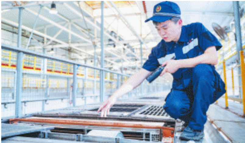
工长袁方对车辆冷凝风机等装置进行检查作业。
