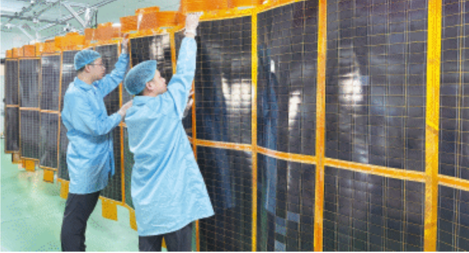
空天动能工作人员在进行卫星太阳翼电池阵展开试验。 长沙晚报全媒体记者 周游 通讯员 刘佳妮 摄影报道
