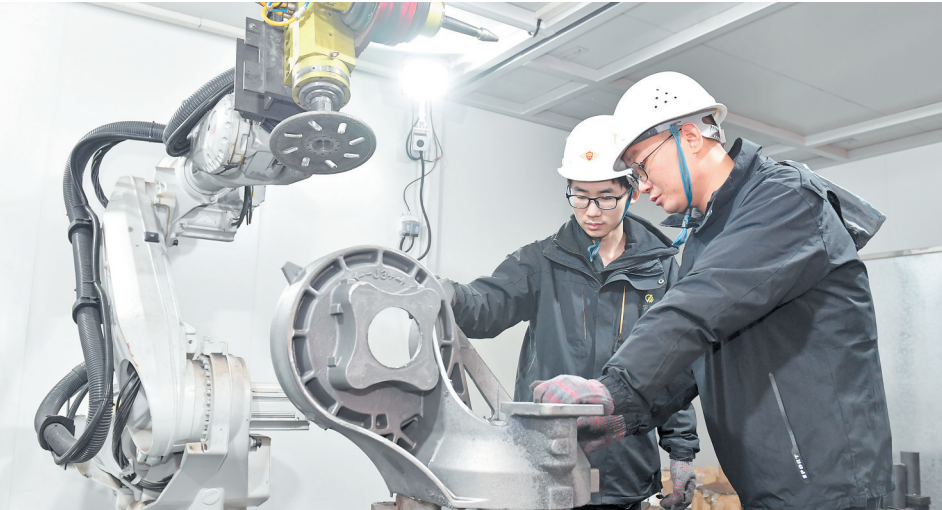
全宇工业通过将AI视觉、机器人技术与工业场景相结合,提升铸件毛坏打磨效率。 长沙晚报全媒体记者 王宏伟 摄
