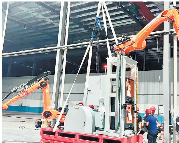
深眸科技AI涂漆机器人由工业视觉系统、涂装系统、泵漆系统、底盘系统四大部分组成。长沙晚报通讯员 欧亚琦 供图
