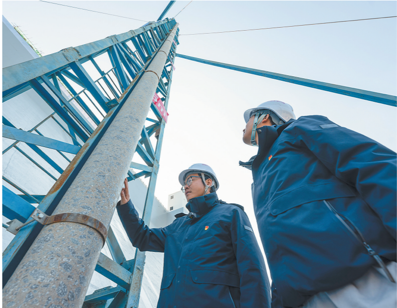
2025年7月1日,项目成功取出长达28.55米、直径273毫米的碾压混凝土芯样,刷新碾压混凝土大坝取芯长度世界纪录。
