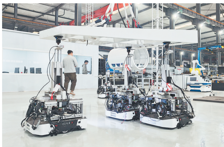
三台机器人在模拟协同对接机翼机身。长沙晚报全媒体记者 徐运源 摄
