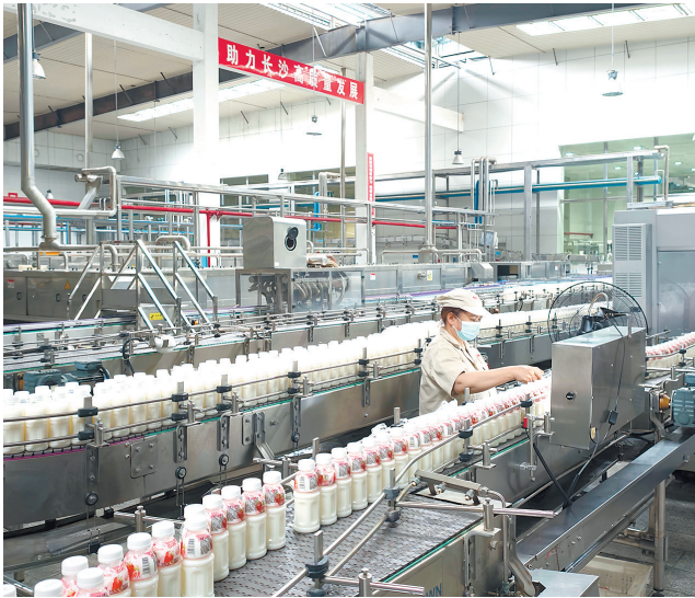
自动化生产线正在高速运转,一瓶瓶印着“小洋人”标识的乳饮料经过消毒、灌装、封盖、贴标,最终打包成箱。长沙晚报通讯员 林佳妮 摄
