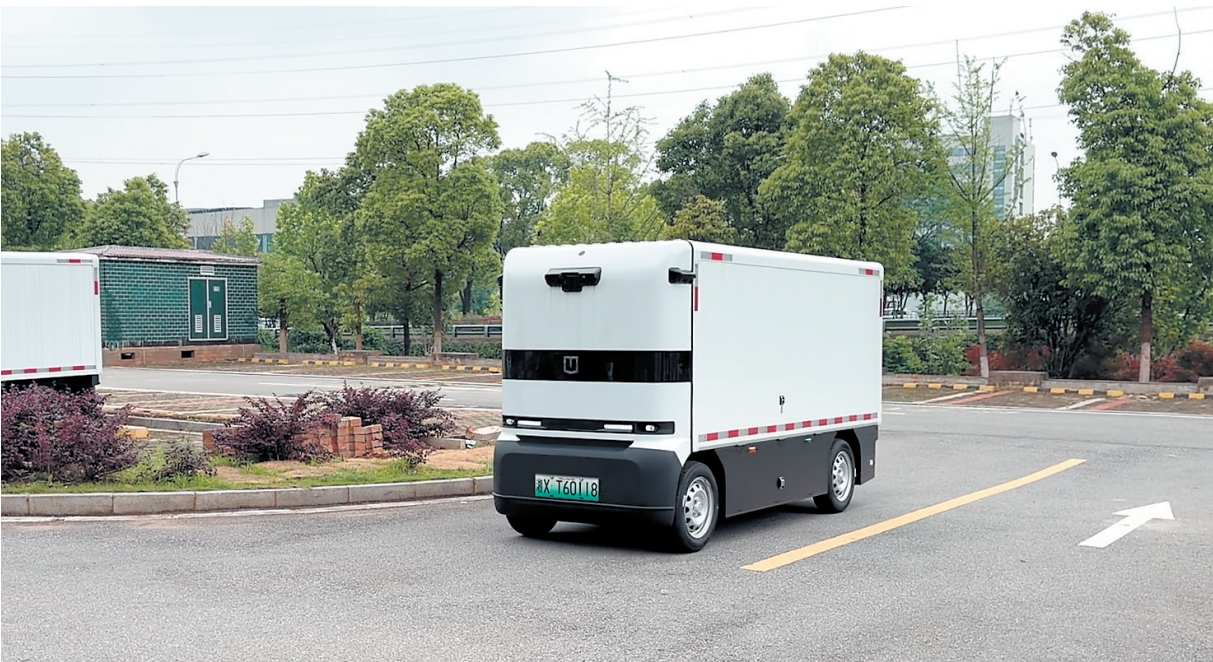
行驶中的行深智能L4级自动驾驶末端配送机器人P6S。
