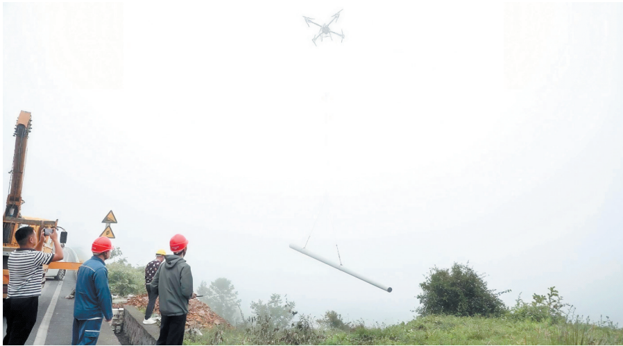
无人机搭载了专用吊运设备,穿越复杂地形,全程飞行稳定、定位精准。长沙晚报通讯员 李晶 胡奥辉供图
